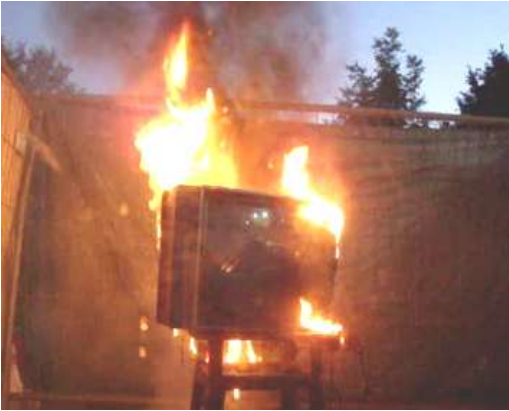
Entflammung nach acht Minuten
